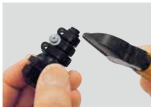
**01** 使用する電線径にあわせてキャブコンをカットする。
